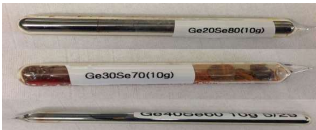
Figure 3.4 \text{Ge}_{20}\text{Se}_{80} , \text{Ge}_{30}\text{Se}_{70} , \text{Ge}_{40}\text{Se}_{60} Chalcogenide Glasses samples.
