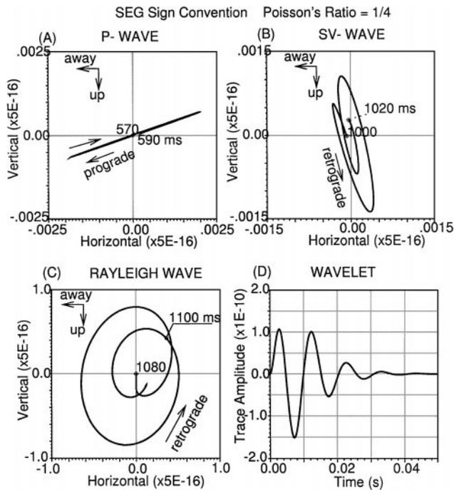
FIG. A-4. Particle velocity hodograms for Figure A-3 synthetic seismograms. (d) Wavelet.
